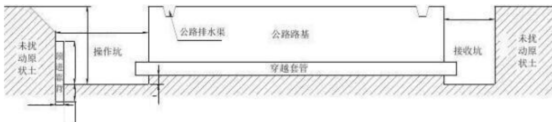
图 3.3-3 穿越道路施工作业示意图
