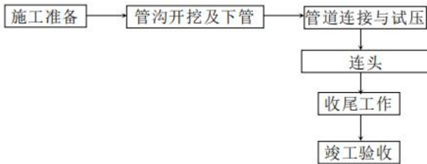
图 3.3-1 管道工程施工阶段工艺流程图
